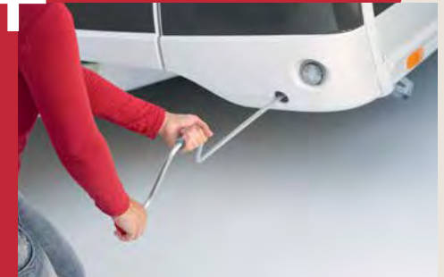
Guía de acceso a patas de estacionamiento para su práctico manejo
