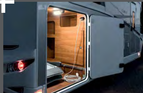
Iluminación y toma de corriente de 230 V en el garaje trasero
