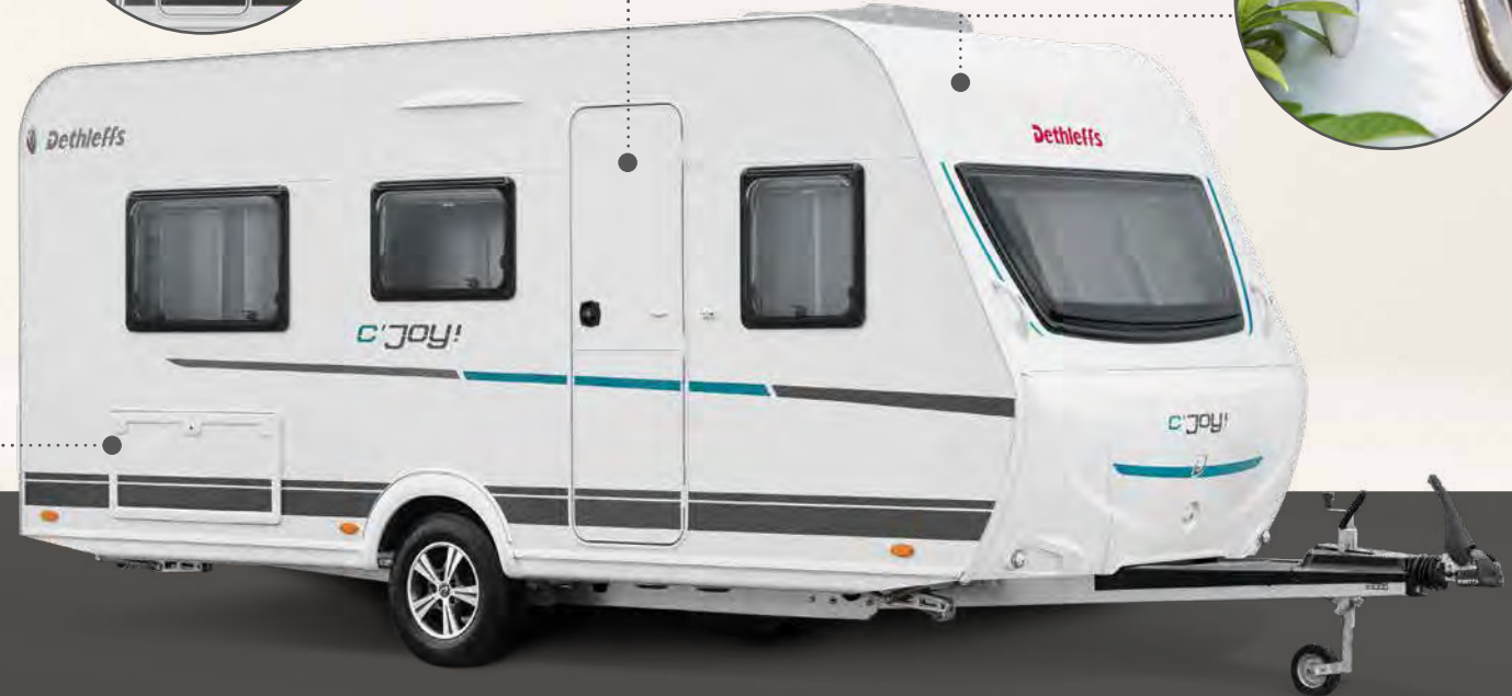
Parte frontal, trasera y techo de resistente GFK
