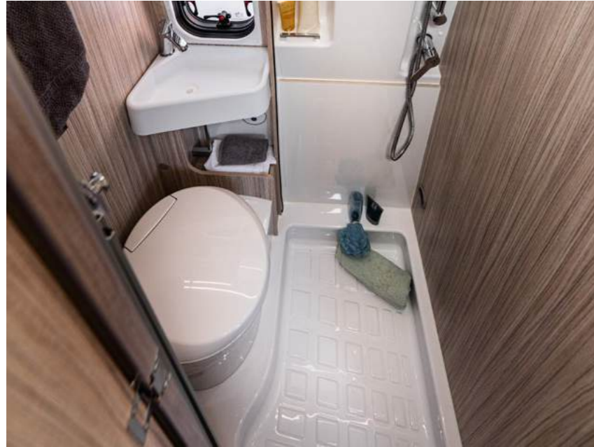
Plato de ducha rebajado (el agua no pasa a la zona WC).
