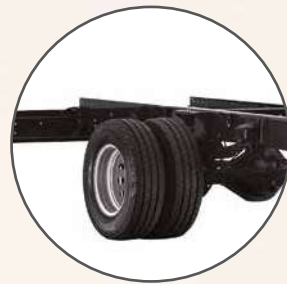
Tracción trasera con ruedas gemelas y suspensión neumática del eje motor
