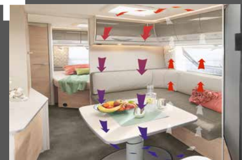
AirPlus: sistema de circulación de aire detrás de los armarios altillos
