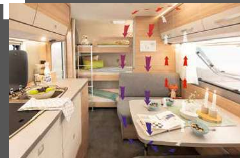
AirPlus: sistema de circulación de aire detrás de los armarios altos
