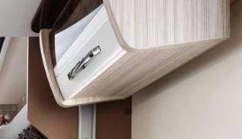
Paneles anticondensación separados de la pared en la zona de día y la zona de descanso para que circule el aire y el calor.
